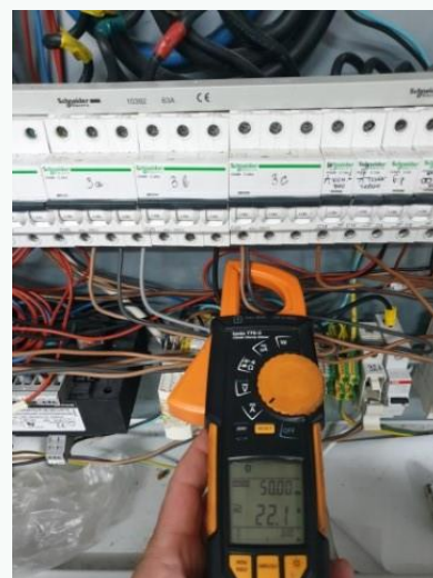
Видимо изображение и полево измерване на ток
